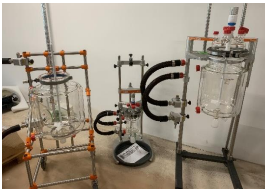
Doppelwand-Reaktoren (Auswahl): in Geometrie und Volumen perfekt aufeinander abgestimmt
