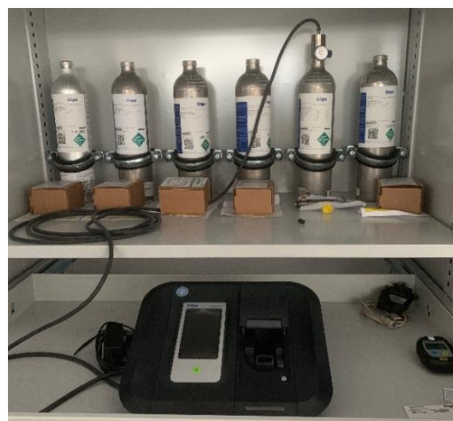
Kalibrierstation mit den verschiedenen Prüfgasen.
