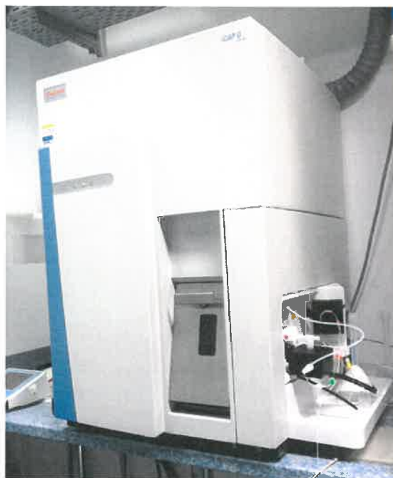
ICP-MS-Massenspektrometrie-Gerät Foto: ChemCon GmbH/Dr. Peter Gockel
